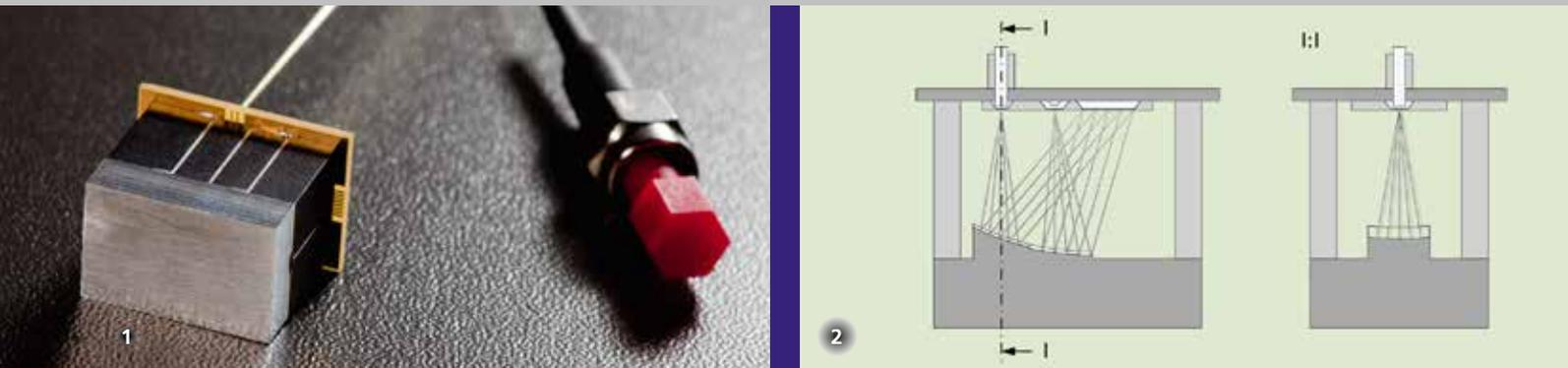
1 NIR-Mikrospektrometer im Volumen eines Stücks Würfelzucker, Messbereich: 950 nm – 1900 nm, spektrale Auflösung: 10 nm.
